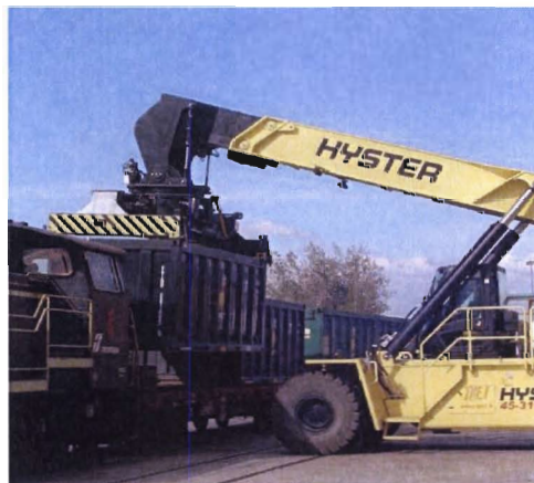
Figura 22: esempio di mezzo gommato per il carico/scarico dei container su/da carri
