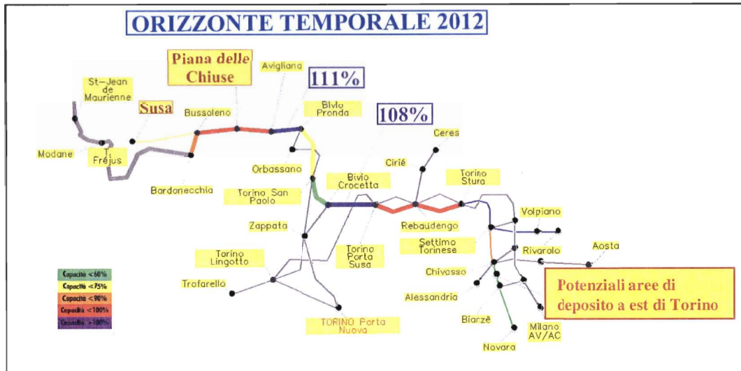
Figura 23: rappresentazione grafica delle tratte con coefficiente di saturazione superiore al 100% all'orizzonte temporale 2012
