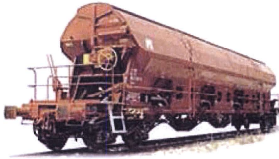
Figura 18: Esempio di carro tramoggia
