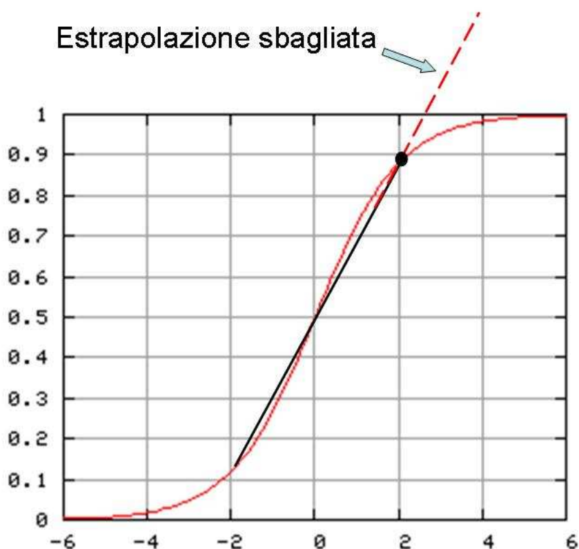
Fig. 3. Se ci si trova in corrispondenza del punto evidenziato in nero, utilizzare l'estrapolazione lineare della pendenza della curva che si ha alle spalle produce risultati completamente sbagliati.
